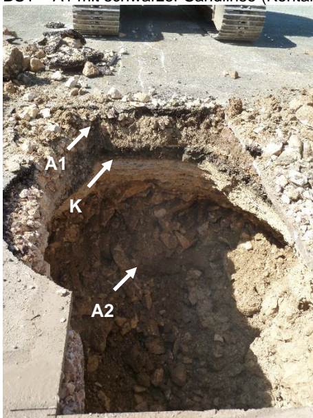
BS1 – Auffüllung, Ausbruchmaterial
