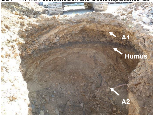
BS4 – Auffüllung (A1, A2) mit alter Humusschicht
